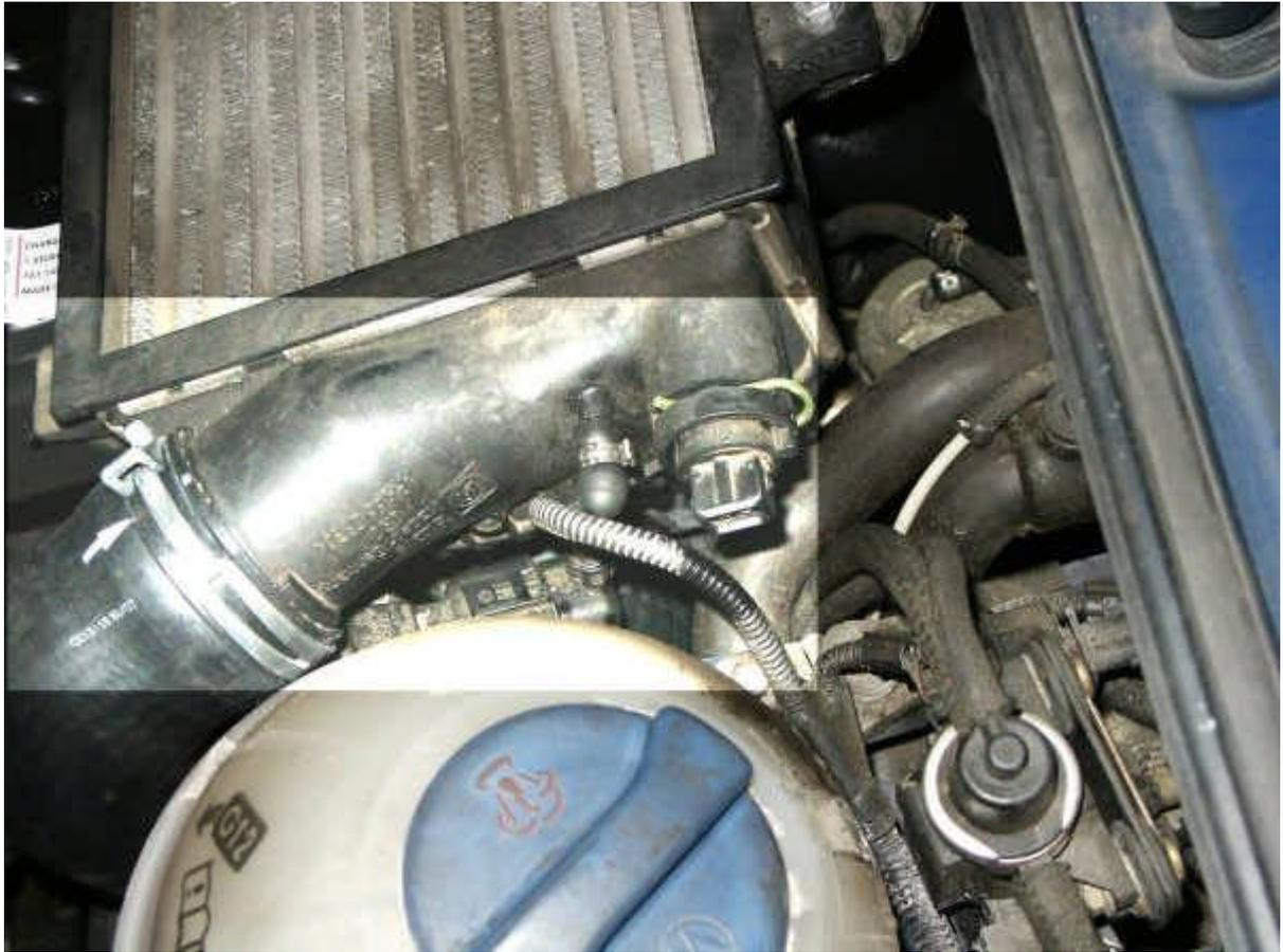
Alter Sensor und Anschlussnippel für Ladedruckanschluss des alten Steuergerät (jetzt für LDA benutzt)
