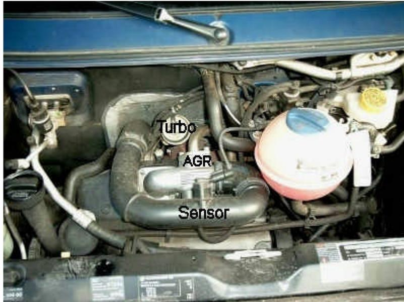
Die Luftführung verläuft vom Turbo zum AGR über zwei Winkelschläuche und einem Plastikrohr mit dem Kombinationssensor.
