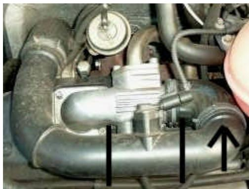
Den Sensor aus dem Rohr mit jeweils 2,5cm heraustrennen (Balken). Dieser wird dann in den Schlauch zu AGR eingesetzt (Pfeil). Dieser Schritt entfällt, wenn die richtige Version des LLK verwendet wird. Der Winkelschlauch am Turbo wird entfernt und durch den vom ACV ersetzt. Der LLK wird mit zwei Halteblechen oberhalb und unterhalb montiert. Oberhalb sind zwei kleine Gewindestangen am Rahmen vorhanden. Unterhalb werden zwei Schrauben in den Kühlerrahmen eingesetzt.
