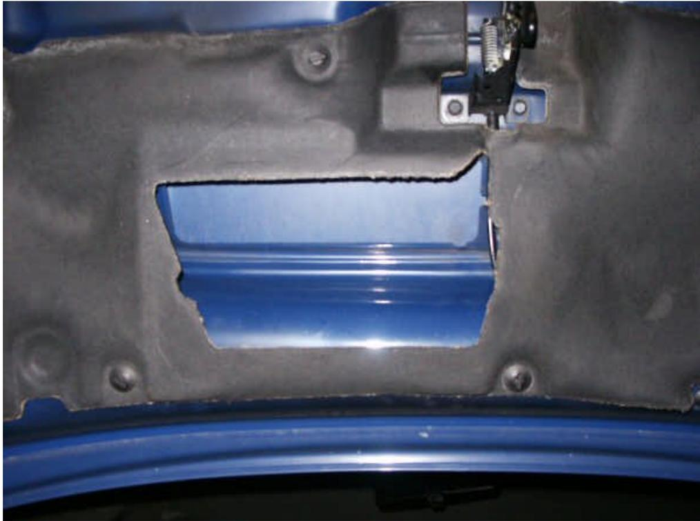
Ausschnitt für die Luftführung in der Motordämmung entfernen (perforiert)
