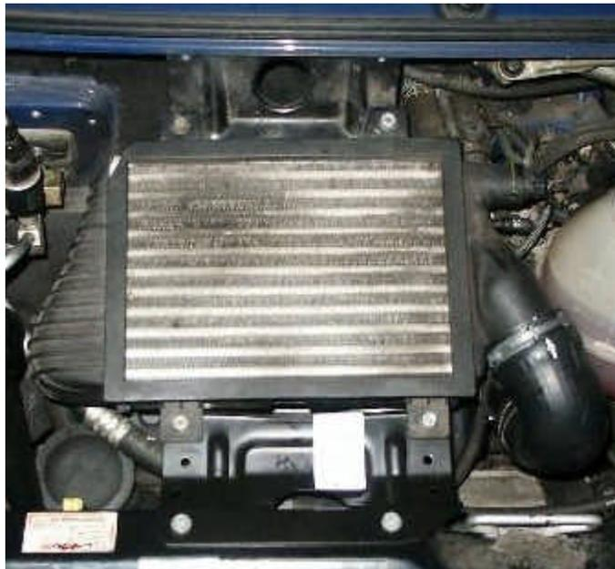
Der LLK selbst wird mit 4 Silentblöcken auf den Haltern aufgesetzt. Der Schlauch vom Turbo wird direkt angeschlossen. Am Ausgang des LLK wird der originale Schlauch angeschlossen, allerdings muss dieser vorher abgeschnitten werden. Der Schnitt erfolgt ca. 3cm nach dem oberen Bogen, so das der Sensor mit dem Rohr genügend weit hinein gesteckt werden kann. Dieser Schritt entfällt ebenfalls, wenn die richtige Version des LLK verwendet wird.
