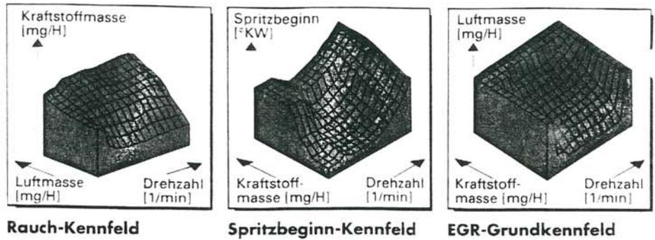
**Bild 8: Kennfelder der elektronischen Dieselregelung**
