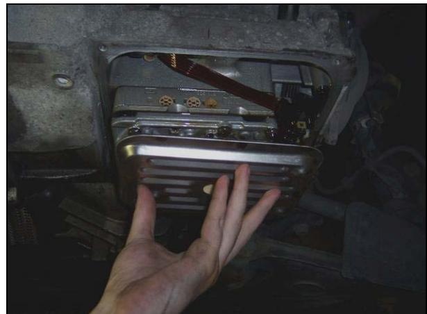
Dazu braucht man aber entweder eine Ölpumpe oder andere Vorrichtung mit einer Schlauchverlängerung um das neue ATF von oben reinfüllen zu können. Wir haben dafür ein ca. 10 mm dickes Schlauch auf einen Trichter drüber gezogen und das Öl von oben eingefüllt.
